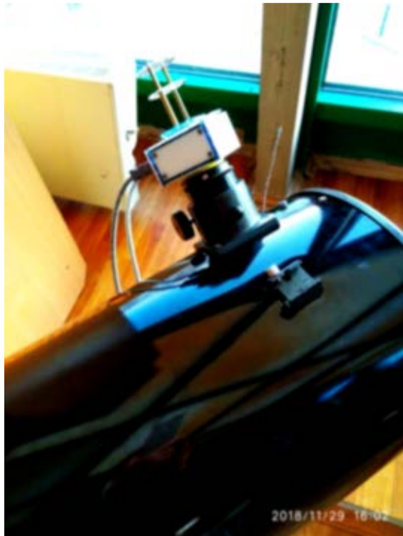
Рис. 3. Считывающая головка прикреплена к телескопу. Фото авторов
