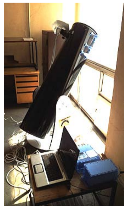
Рис. 2. Телескоп-рефлектор: 1 — монтировка телескопа; 2 — труба телескопа; 3 — головка измерительная; 4 — прицел теневой. Фото авторов
